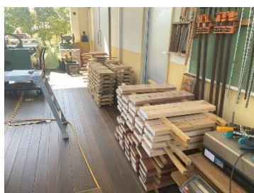
図-1 天然乾燥試験の積み重ね状況
