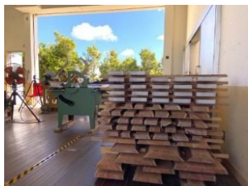
図-1 天然乾燥試験の積み重ね状況
