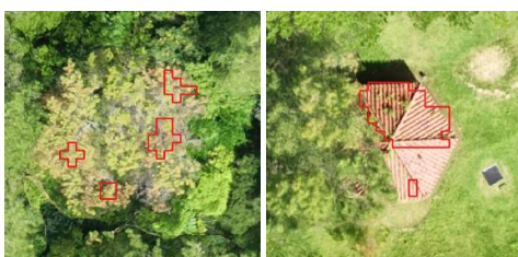
図-3 空振りの例 (左:重複、右:不在、赤枠は枯れ松と予測された範囲を示す)
