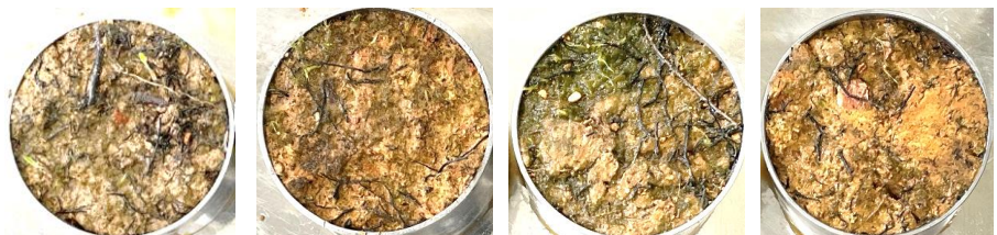
図-4 コシダなし区 4 か所の飽和透水係数測定試料中に残存するコシダの根系
