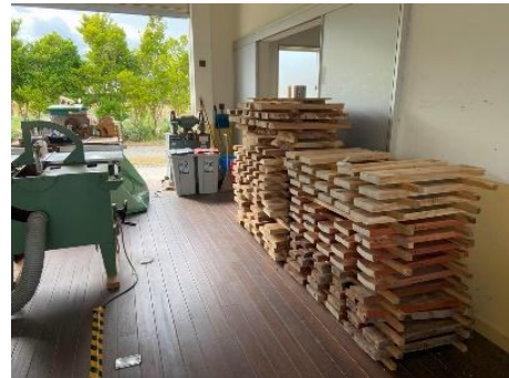
図-4 天然乾燥試験の積み重ね状況（手前側上段：クスノキ）
