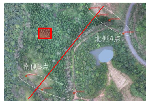
図-1 調査地と GCP 設置状況 (赤線は断面図のライン、赤枠は樹高の精度検証の調査地)
