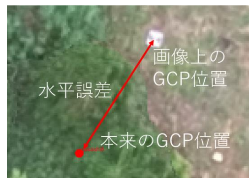
図-2 水平誤差の算出方法の例
