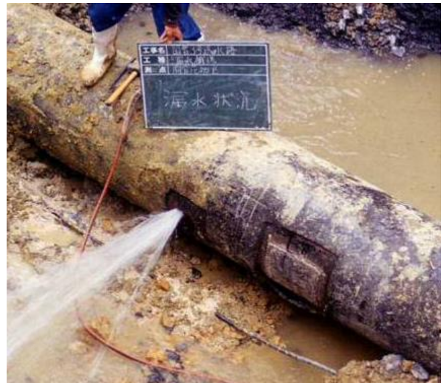
農業水利施設の漏水状況
