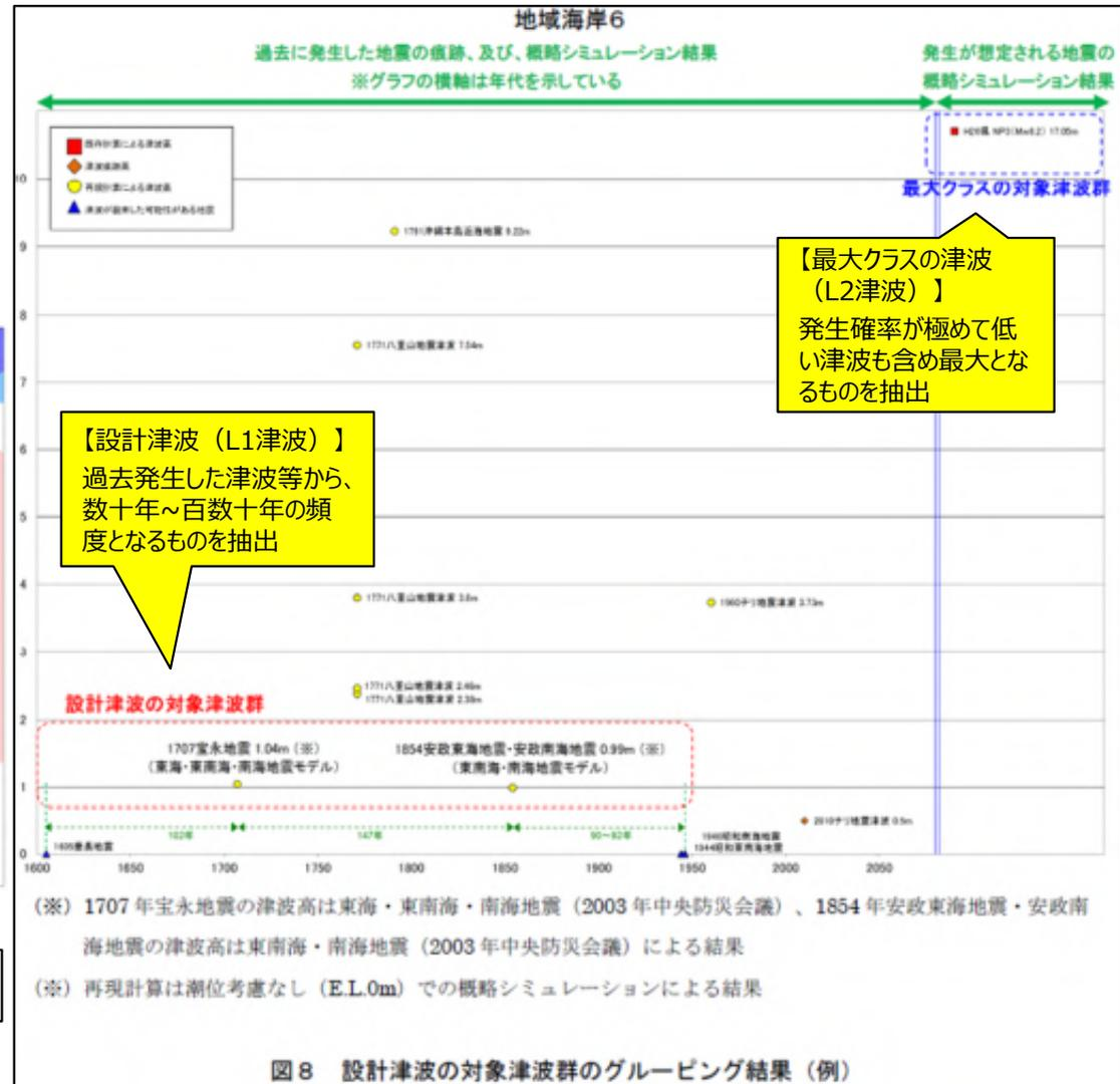
図8 設計津波の対象津波群のグルーピング結果 (例)
