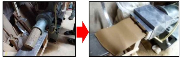
■ 押出形状を矩形断面へ変換する口金を製作
