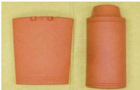
再建される首里城に用いる瓦の製造方法を検証。この製造方法で生産が開始された。
