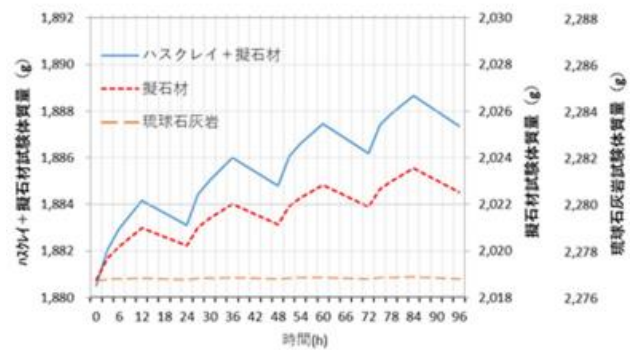
図3 湿度応答法による吸放質量の変化(中湿域)
