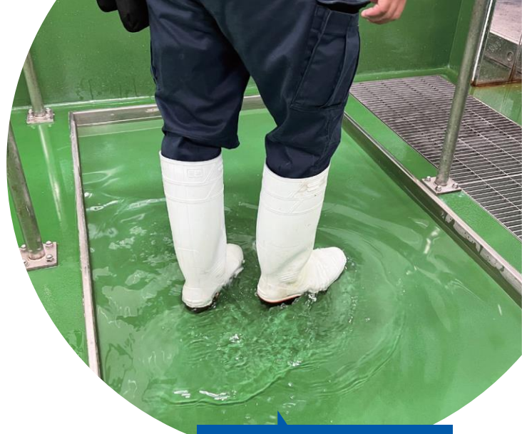
長靴を消毒槽につけ、靴の溝などに付着した汚れも排除、しっかり消毒を行います。
