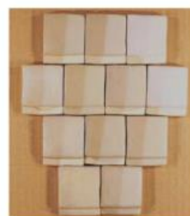
三角座標による釉調合試験の結果
