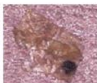
図2 実体顕微鏡観察、EDXによる元素分析により、コゲと推定
