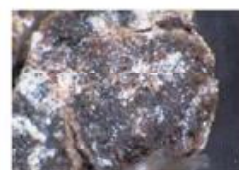
図5 赤外分光光度計により、実の結晶物と推定
