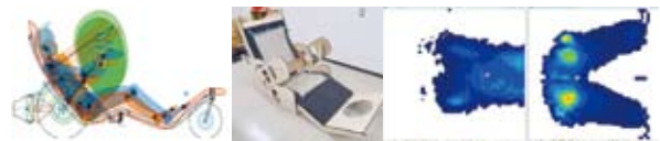
動作範囲のシミュレーションと実験機による体圧分布測定
