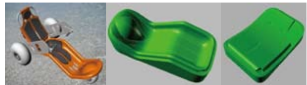
3D-CAD 設計と連携したシート形状加工用 CAM データ
