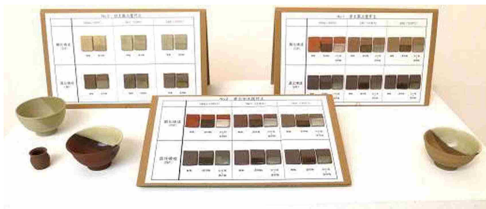
写真 基礎坯土3種（赤土高火度、赤土中火度、白土高火度）のテストピース
