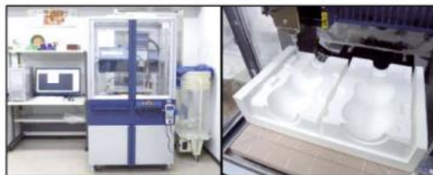
図2 原型加工装置(左)と石膏型の加工(右)
