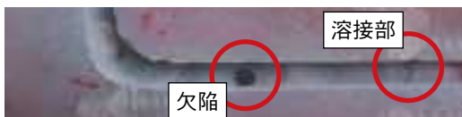
図2 浸透探傷試験：欠陥例
