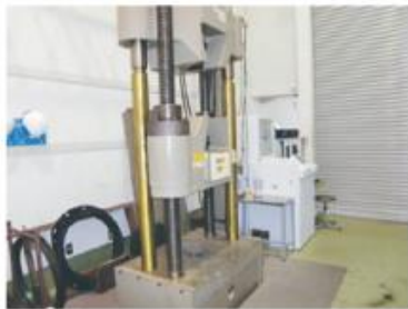
図1 万能試験機による引張試験
