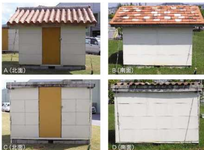
図1 屋外での温度測定小屋 (A: 在来瓦、B: 新瓦(波瓦)、C: 瓦なし、D: 断熱瓦)
