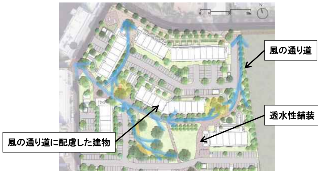
図Ⅱ-17 雨水の地下浸透、貯留と風の通り道に配慮した建物の形状と配置の例
