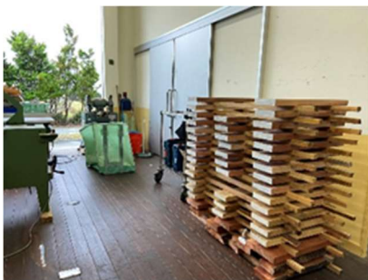
図-3 天然乾燥試験の積み重ね状況
