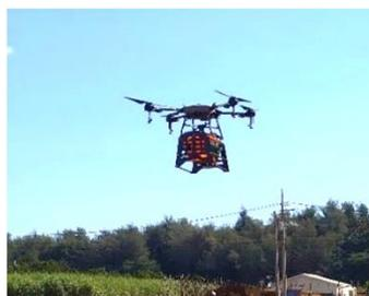
←ハリガネムシ対策用交信かく乱性フェロモンチューブの空中散布用に開発されたドローン
