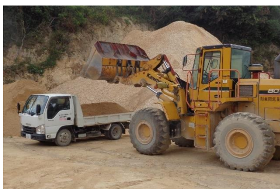
鉱山にてイシグーを積載。写真は2tトラックへ積載しているところ。
