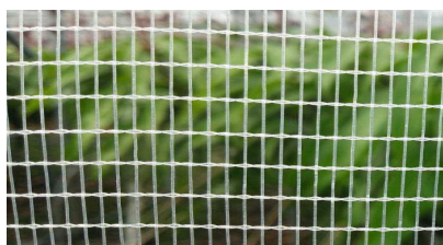
写真7 側窓ネット (2×6mm)
