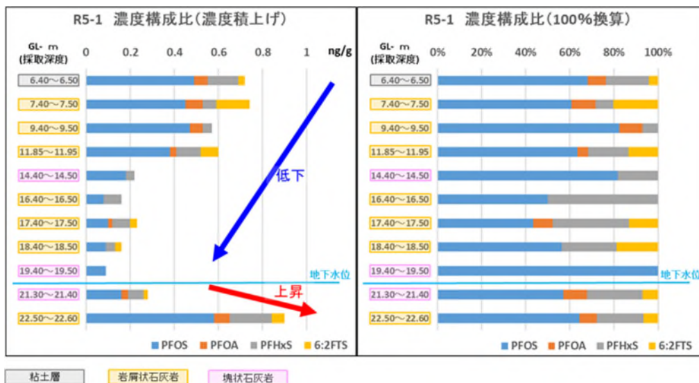
図 2.5.5 深度方向の石灰岩等における PFOS 等の濃度構成比 (R5-1 孔)
