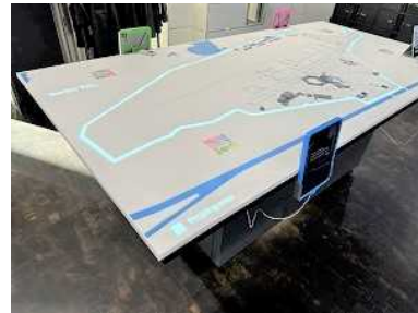
白地図模型(縮尺1:2000)にプロジェクター投影し、各エリア等を解説 ※タブレットで操作 黒色：既存建物 白色：新規建物(計画中) 灰色：新規建物(完成)
