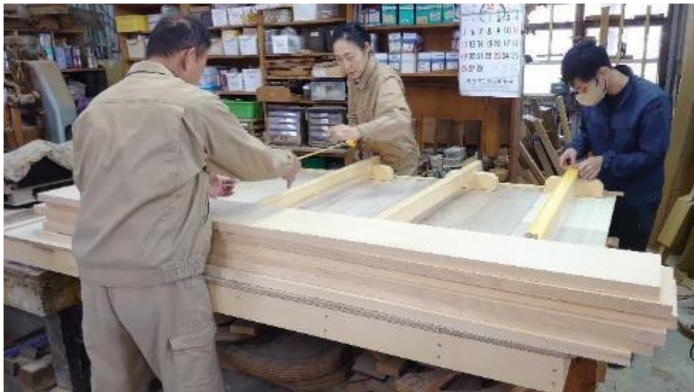
木脚のテープ養生（膠でくっつかないようにする）
