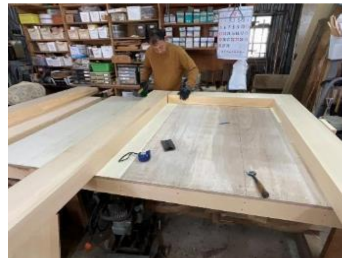
仮組みによる確認
