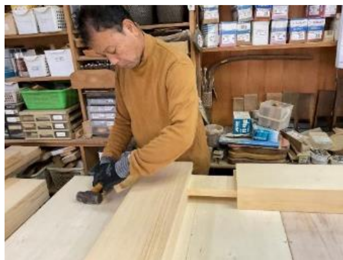
仮組みによる確認
