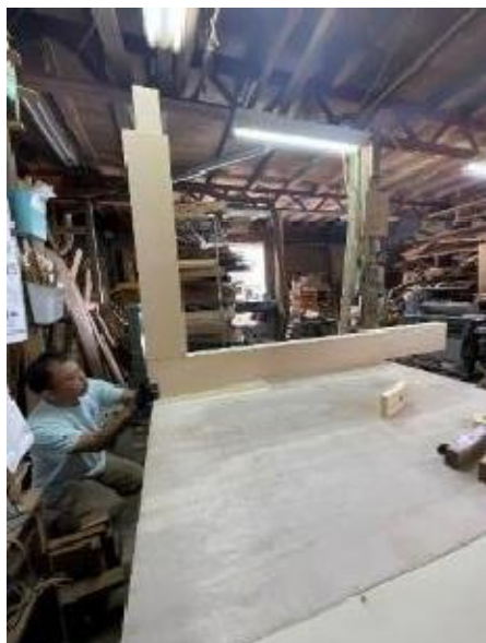
仮組みによる確認
