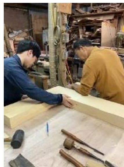
仮組みによる確認
