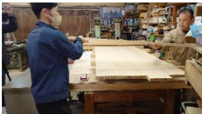
地板材の仮置き
