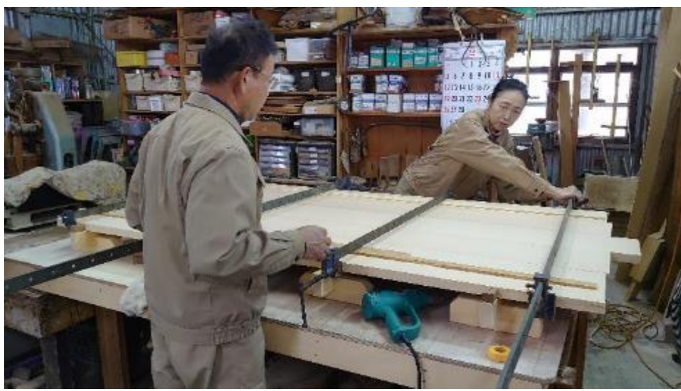
接着面の締め付け作業
