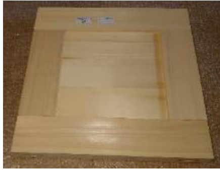
組んだ状態 1 / 2 部分試作 枠部厚90mm
