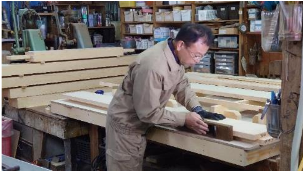
地板材 接合面の削り
