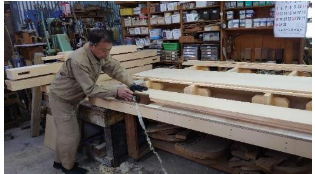
地板材 接合面の削り
