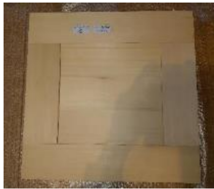
組んだ状態 1 / 2 部分試作 枠部厚75mm
