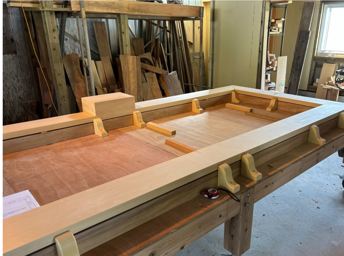
額縁躯体と額縁彫刻部の仮組み状況
