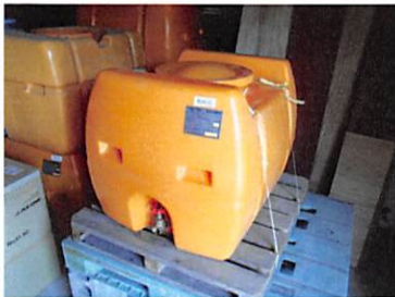
写真1 農業用貯水タンク
