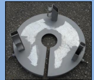
攪拌機固定器 (当所で作製)
