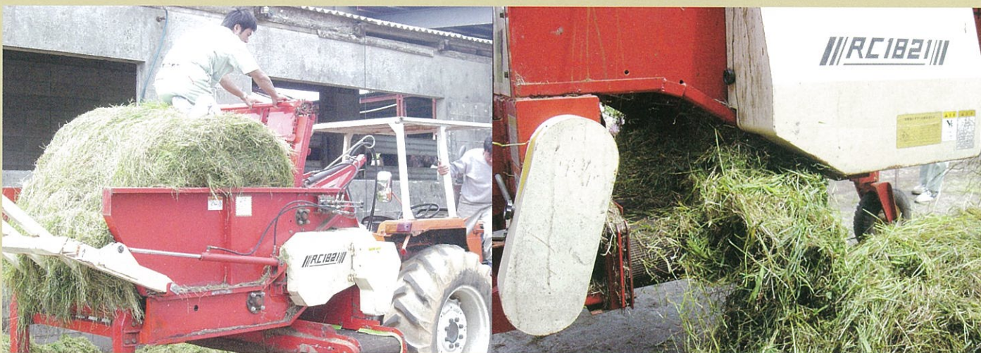
ロールベールカッターを用いた苗の切断
