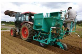
ビレットプランタによる サトウキビ植え付け試験
