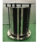
合成性フェロモン 封入揮発装置
