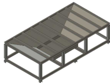
b) 回収装置 (グレーチングなし)
