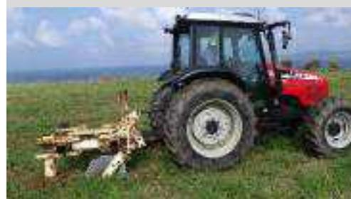
土層内に硬盤（心土）があることにより、ほ場の排水性が悪くなります。そのため、サブソイラー等により心土を破碎し、雨水の地下浸透を促します。
