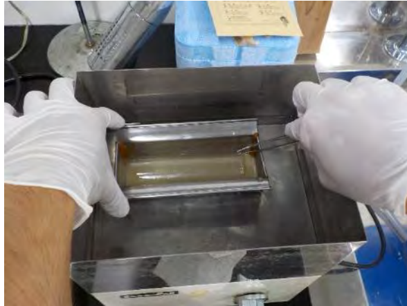
写真 4-5-2.2 超音波洗浄機による成分の抽出
