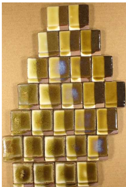
図18 具志頭白土－土灰－ニービ配合系による鉄釉試験
