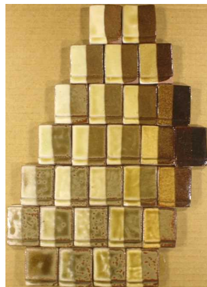
図17 具志頭白土－土灰－兼筒段粘土配合系による鉄釉試験
