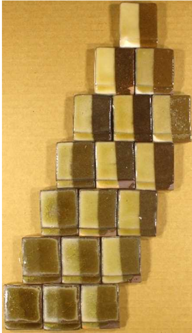
図15 具志頭白土－土灰－白化粧土配合系による鉄釉試験
