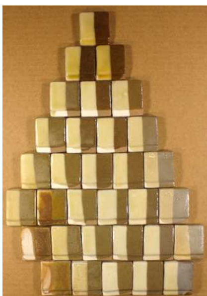
図 13 具志頭白土－シルグスイのもと－白化粧土配合系による基礎釉試験
