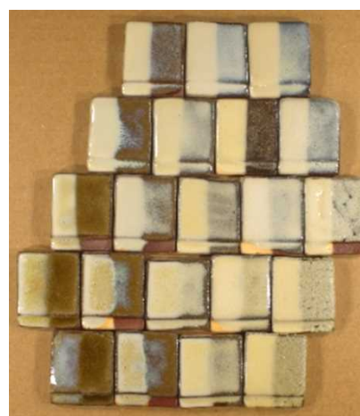
図 14 具志頭白土－土灰－ワラ灰配合系による基礎釉試験
