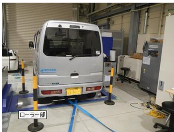
図 7 軽貨物EVをセットした状態(後方より)
