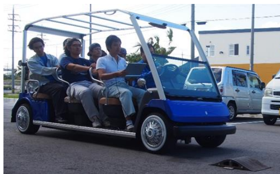
図20 コミュニティビークルひずみ測定試験状況
