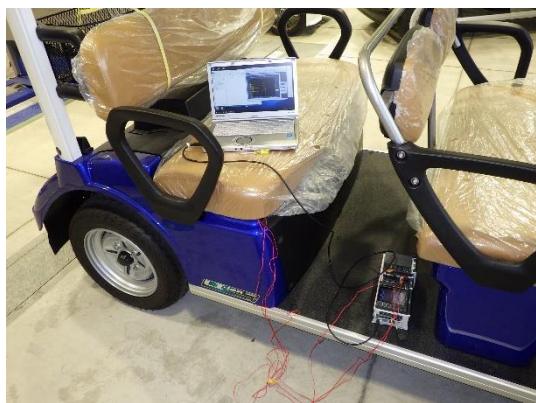
図19 ひずみ計測装置設置状況
