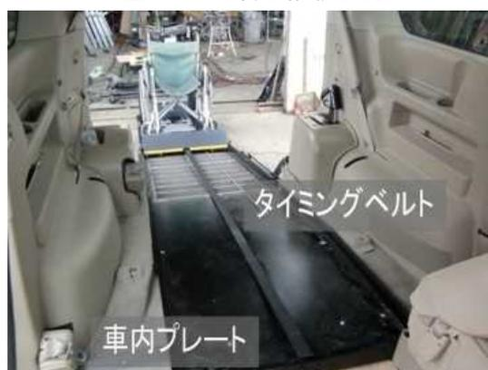
図3.5 車椅子搭載状況（車両内より）
