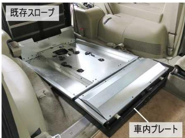
図 4.8 研究車両への設置状況
