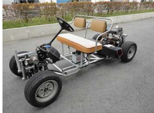
図19. トポロジー最適化フレームの評価用車両
