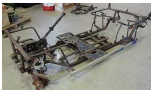
図 2. フレームの腐食
