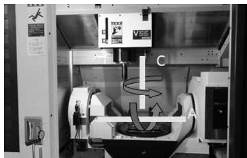
図 1. 5 軸加工機の回転軸
