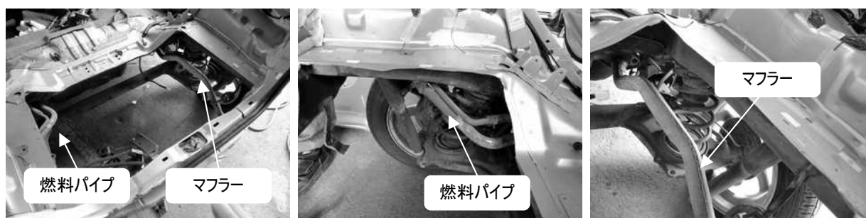
図 3.3 床部切断状況
