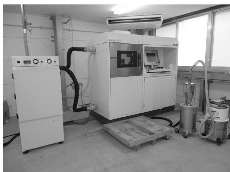
図18 金属粉末積層造型機
