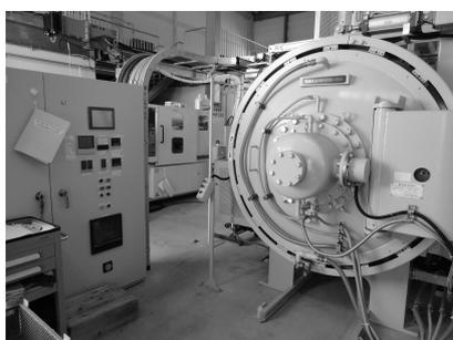
図15 真空熱処理炉
