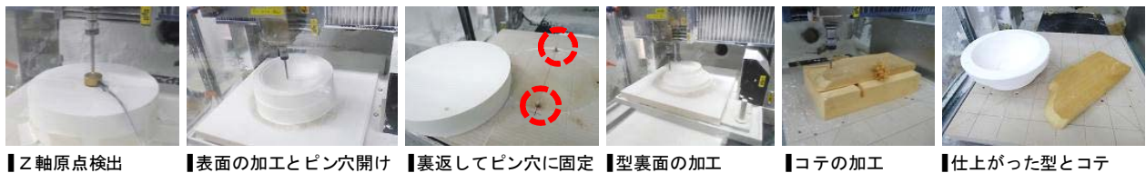
図13 加工状況（機械ロクロ用石膏型と木ゴテ）
