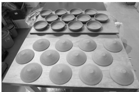
図4 機械ロクロ成形したテストピース
