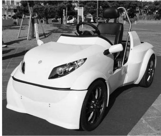
図8 試作した小型電気自動車
