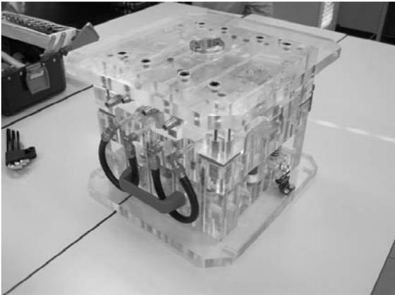
図6 アクリル製金型モデル
