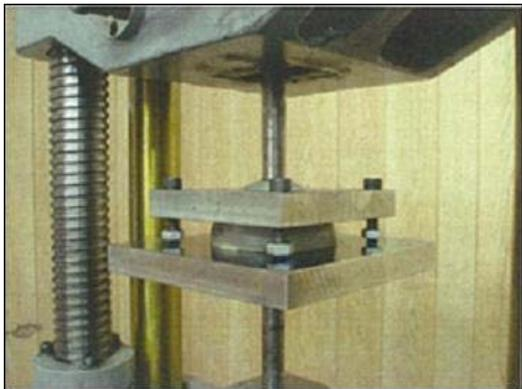
図19 引張試験（ネジ強度の確認）
