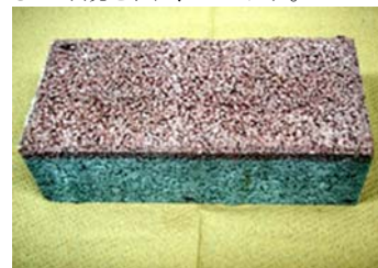
図5 試作した保水性舗装用インターロッキングブロック
