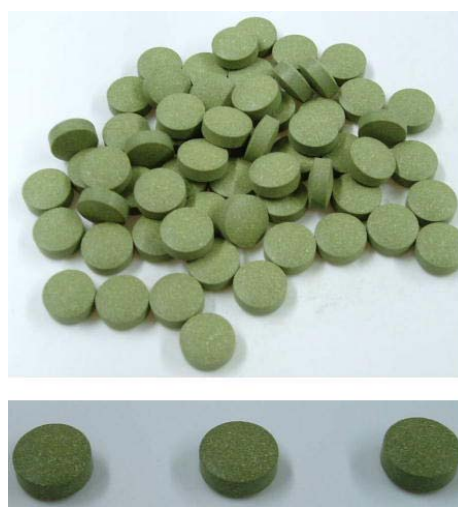
図9 エンサイ粉末の1%アルギン酸Na造粒物を用いた試験錠剤
