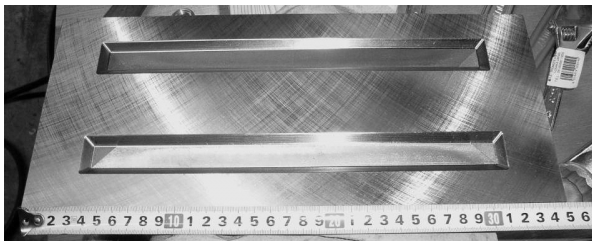
図6 線状突起ブロック用金型概観 (SS400製)
