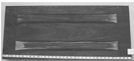
図7 タンニン鉄により変色した線状突起ブロック
