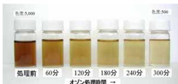
図 15 膜透過液のオゾン処理による色調の変化
