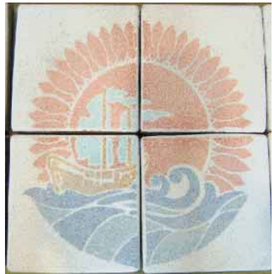
図15 300角平板を4枚使用した試作品 (爬竜船)
